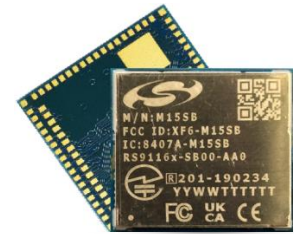
LGA Module (AA0) 14 mm x 15 mm
