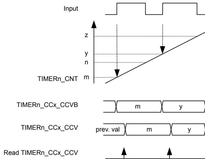
**Figure 20.12. TIMER/WTIMER Input Capture**
